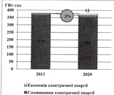
Рисунок 3.4.1. Зниження споживання електричної енергії в системі водопостачання та водовідведення
