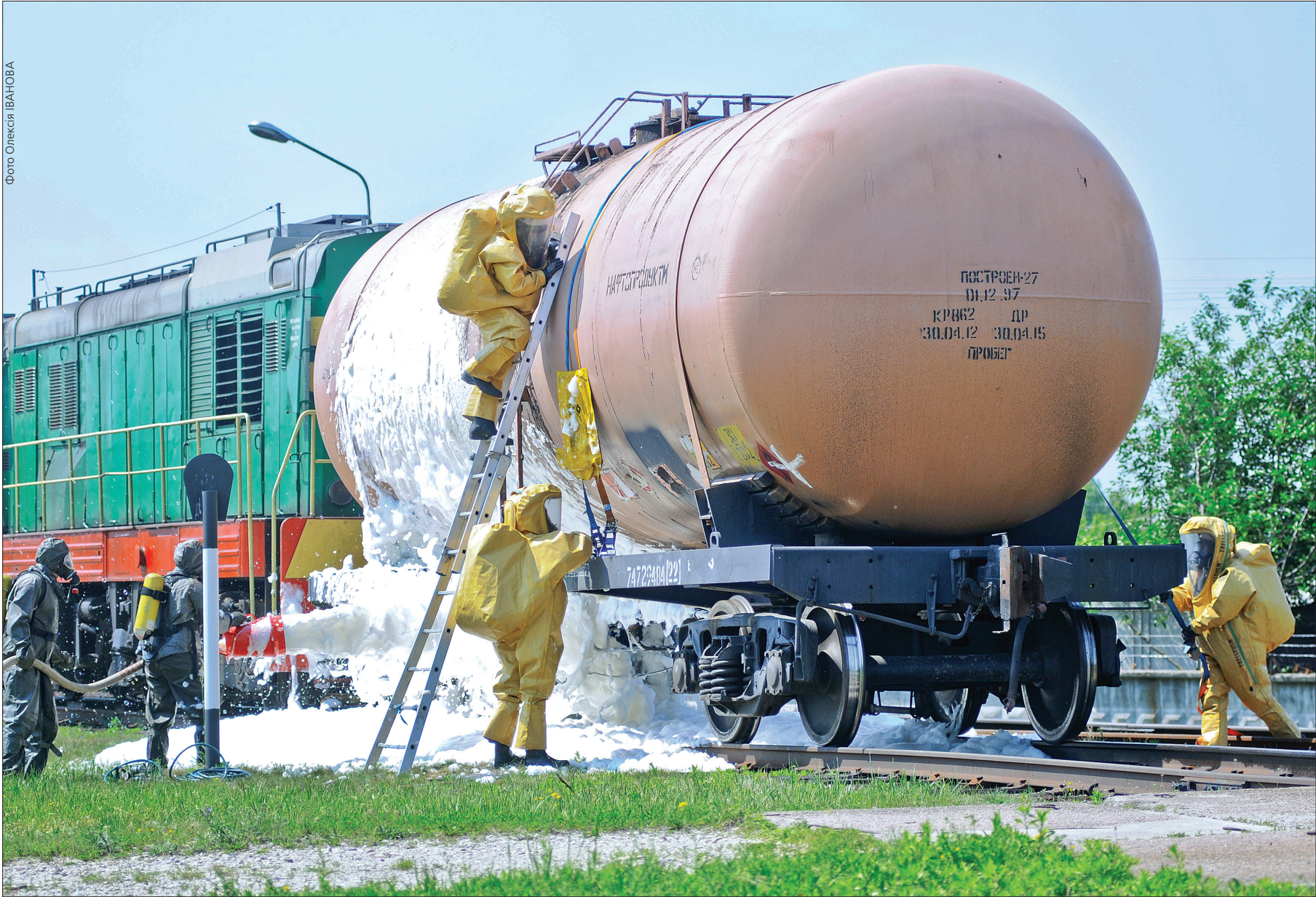
Поки тривала ліквідація витоку, на місце події прибув пожежний аварійно-рятувальний підрозділ, який подавав піну для того, щоб не дати можливості хлору випаровуватись та переходити в газоподібний стан
