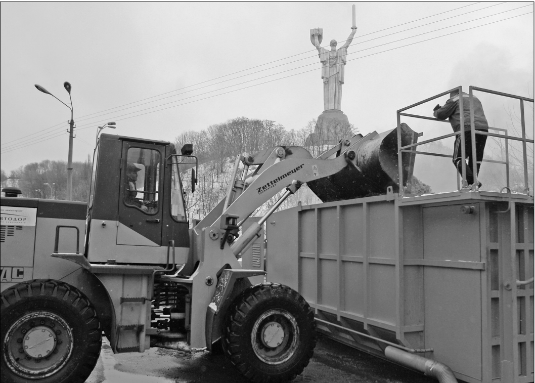
За одну годину машина розтоплює в середньому 120 кубічних метрів снігу, а максимальна її потужність 150 кубічних метрів
