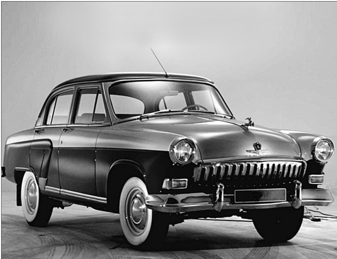
В два цвета окрашивали специальный экспортный вариант “Волги”. На снимке тот вариант, который оснащался автоматической коробкой передач
