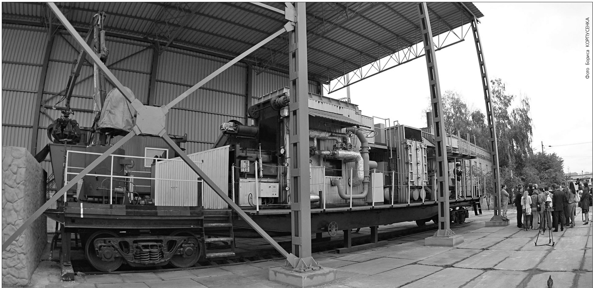
Мобільна установка із переробки твердих побутових відходів МПК-400 розміром у звичайний залізничний вагон
