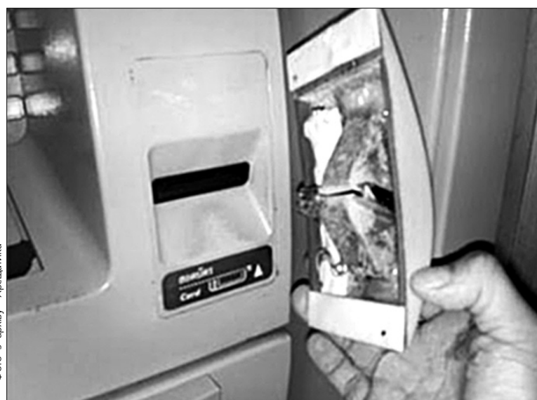
Зловмисники прилаштовують скімер над щільною для картки, тож клієнт банку гарантовано пропускає картку через нього
